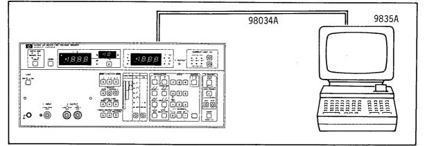
Figure 4-9. HP-IB Interface Test Setup.
